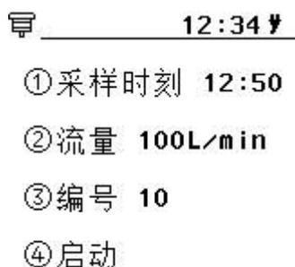
图 14 粉尘采样设置界面
